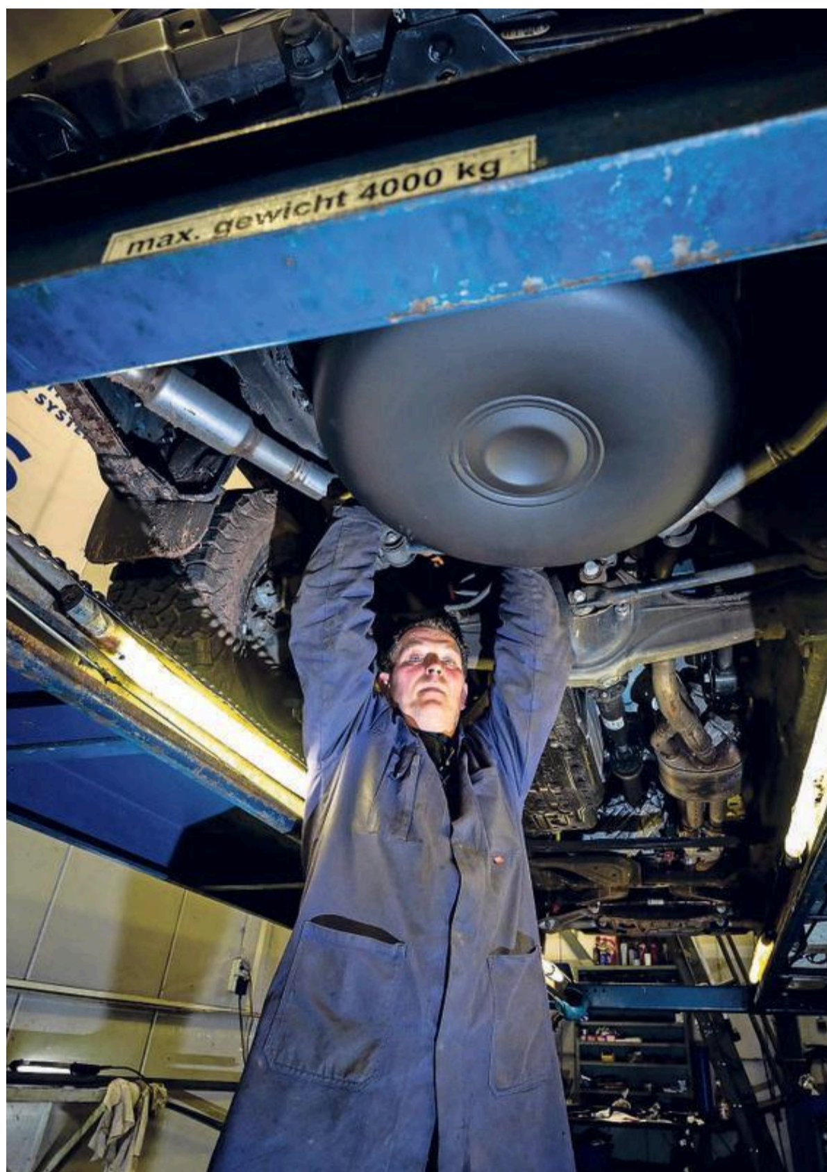
Don van Ommeren bij de lpg-tank die hij aan het inbouwen is.
