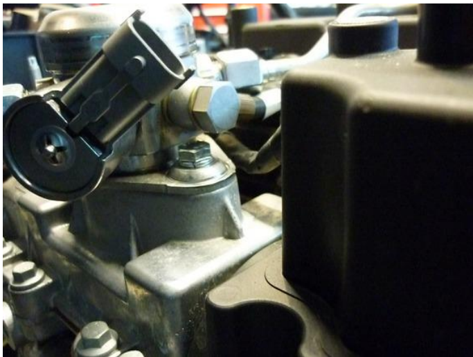
Replace original M6 bolt for normal M6x25
