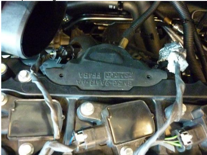
Replace original M6 bolt for normal M6x25
