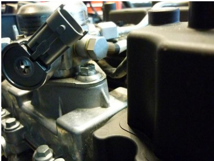
Replace original M6 bolt for normal M6x25
