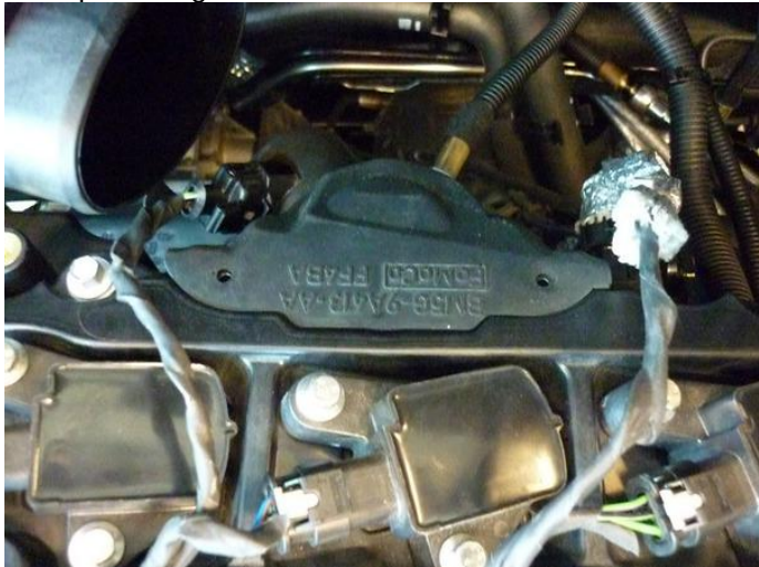
Replace original M6 bolt for normal M6x25
