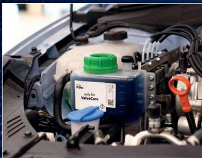
**ValveCare-3 è un sistema di dosaggio a controllo elettronico per motori a benzina convertiti a GPL o metano. Insieme all'additivo Prins ValveCare, il sistema aiuta a mantenere la camera di combustione più pulita e a ridurre l'usura di valvole, sedi valvole e iniettori benzina.**
