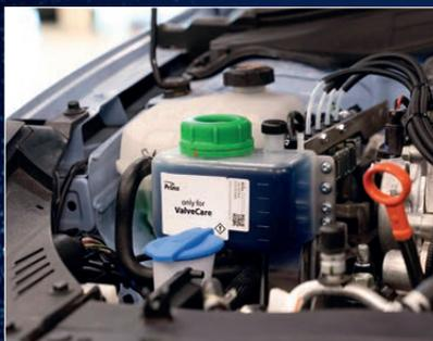
**Le ValveCare-3 est un système de dosage électroniquement contrôlé pour les moteurs à essence transformés au GPL ou GNV. Associé à l'additif Prins ValveCare, le système permet de garder la chambre de combustion propre, et de réduire l'usure prématurée des soupapes, des sièges de soupape et des injecteurs essence.**
